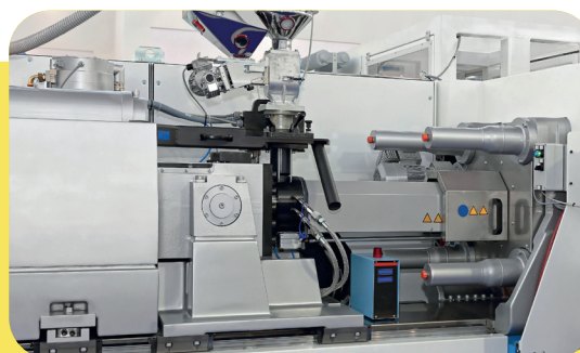
Lubrification de guides en injection plastique.
